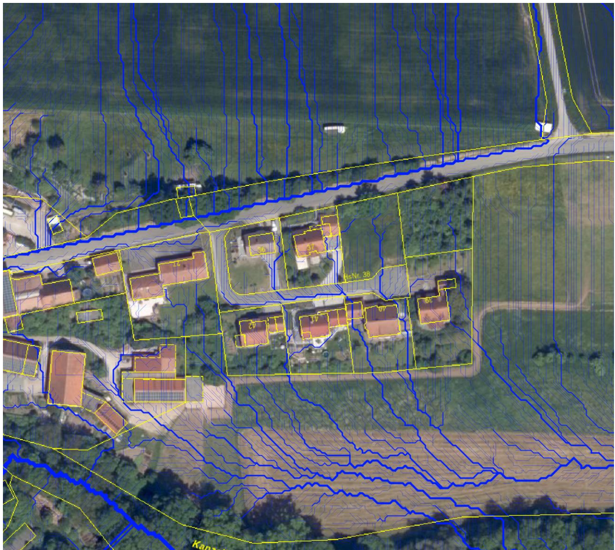
Luftbild o. M. mit Darstellung potenzieller Fließwege (blaue Linien) wild abfließenden Niederschlagswassers © Luftbild und Grundstücksteilung Bay. Vermessungsverwaltung 2024
